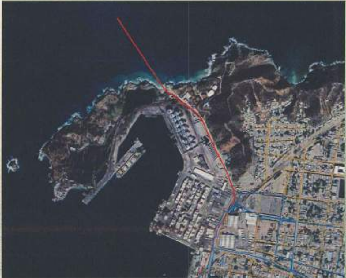
Ilustración 31. Tramo líneas de impulsión de 1000 mm (40") y 600 mm (24") y emisario submarino.
